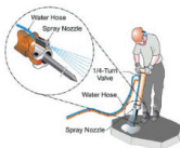
그림 2. 스프레이 노즐이 부착된 잭해머(콘크리트 파쇄작업에 적합) (출처: Worklace Solutions, NIOSH 2009)
