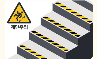
※ 계단 및 작업장 미끄럼 방지 조치
