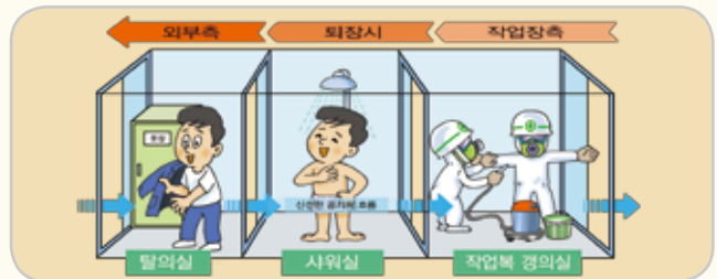
작업 후 위생설비 사용방법 예
